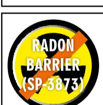
Testet i overensstemmelse med SP-metode 3873: Radontransmittans ( $P$ ) $<6,8 \cdot 10^{-11} \text{ m/s}$ ; Radonmodstand ( $Z$ ) $>1,5 \cdot 10^{-10} \text{ s/m}$ .
