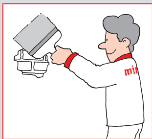
Sår og huller i underlaget udsparies først.
