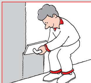
Fuldspartlingen foretages med en bred stålspartel.
